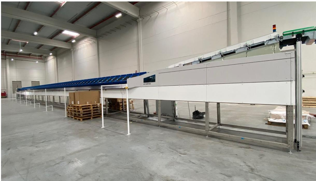
*Vista de la instalación de Mox realizada por JHernando y Equinox: a la izquierda puede apreciarse una entrada automática curva que deposita automáticamente los paquetes en el sorter de la derecha.*
