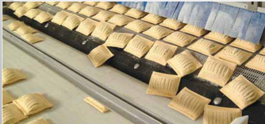
Banda Eyelink utilizada en un túnel de congelado en Bakkersland, Hoogeveen, Holanda.
